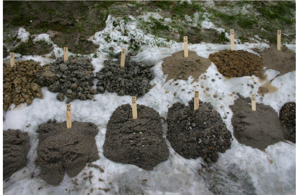
Beprobung der Bohrung und Auslegung des Bohrgutes für die sedimentologische Ansprache sowie die Erstellung von Schichtenverzeichnissen und Bohrprofilen.
